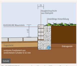
Die KLASSIKLINE Gartenmauer kann bis zu einer Höhe von 42 cm ohne statischen Nachweis mit Erddruck belastet werden.
