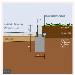
Die BASICWALL Gartenmauer kann bis zu einer Höhe von 27 cm ohne statischen Nachweis mit Erddruck belastet werden.
