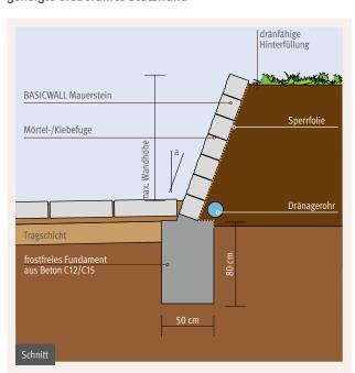
Die BASICWALL Gartenmauer kann als geneigte erdberührte Stützwand bei Einhaltung der maximalen Wandhöhe ohne Verstärkung belastet werden.
