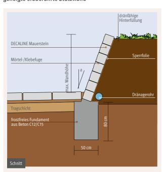
Die DECALINE Gartenmauer kann als geneigte erdberührte Stützwand bei Einhaltung der maximalen Wandhöhe ohne Verstärkung belastet werden.
