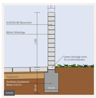
Ohne Verstärkung darf die Wand im nicht öffentlichen Bereich und in windgeschützten Lagen eine maximale Höhe von 200 cm nicht überschreiten, sofern keine einschränkenden bauaufsichtlichen Auflagen bestehen. Ansonsten ist ein statischer Nachweis zu führen. Es wird empfohlen, die Lager- und Stoßfugen der Wand zu vermörteln bzw. zu verkleben.
