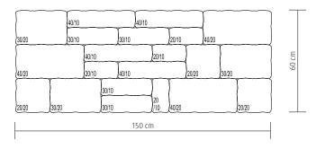
Das Modul  $150/60 \text{ cm} (0,90 \text{ m}^2 = 432,0 \text{ kg})$  besteht aus:
