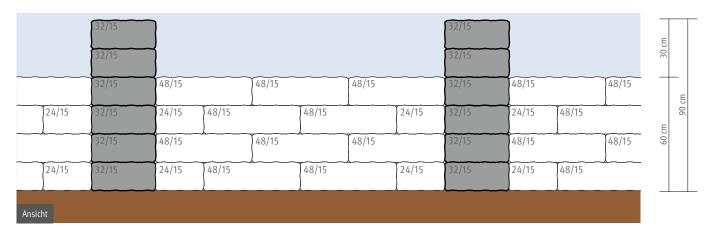
Variante 2 - Schichtenmauerwerk - verschiedene Höhen - Stein 1, 4, 6, 9, 11 und 14
