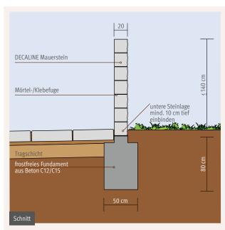
Ohne Verstärkung darf die Wand im nicht öffentlichen Bereich und in windgeschützten Lagen eine maximale Höhe von 140 cm nicht überschreiten, sofern keine einschränkenden bauaufsichtlichen Auflagen bestehen. Ansonsten ist ein statischer Nachweis zu führen. Es wird empfohlen, die Lager- und Stoßfugen der Wand zu vermörteln bzw. zu verkleben.
