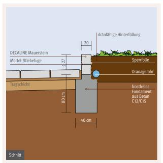
Die DECALINE Gartenmauer kann bis zu einer Höhe von 27 cm ohne statischen Nachweis mit Erddruck belastet werden.
